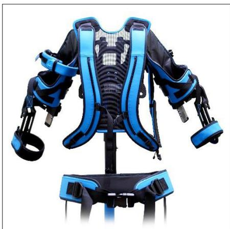
Fig. 4. EksoUE exoskeleton [8].
